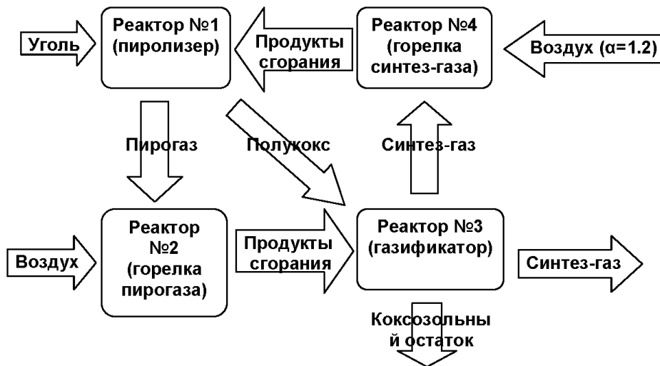
Рисунок 3.13 – Схема ступенчатого процесса газификации угля [663]
