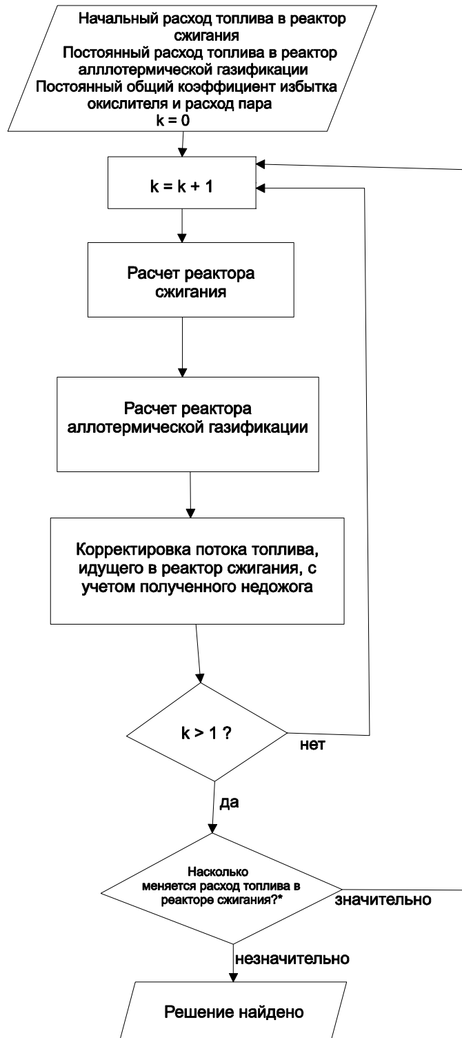
Рисунок 5.15 – Схема численного алгоритма для расчета двухступенчатого реактора с учетом рециркуляции коксозольного остатка
