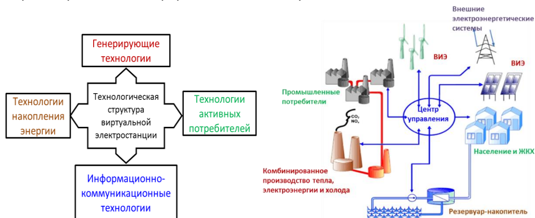
Рис. 87. Технологическая структура виртуальной электростанции.
