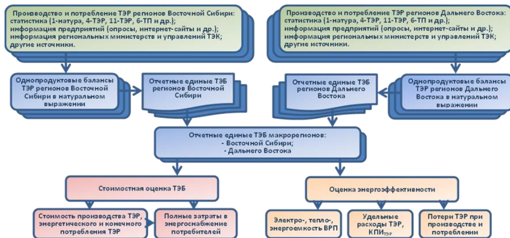
Рис. 52. Схема формирования отчетных ТЭБ восточных регионов России и исследования на их основе показателей энергоэффективности.
