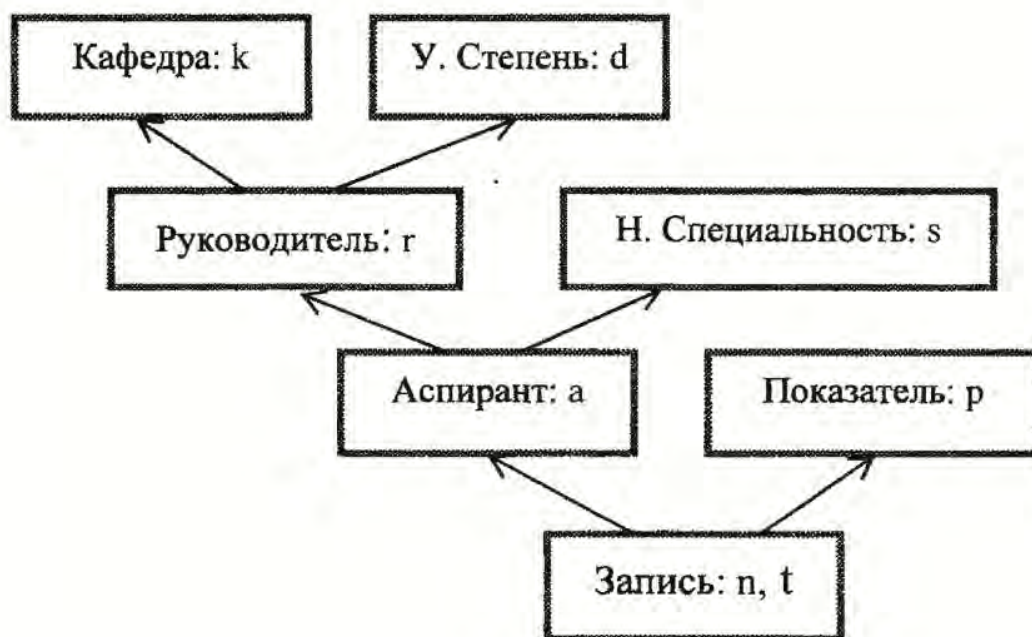
Рис. 6. Структура модели данных «Снежинка»
