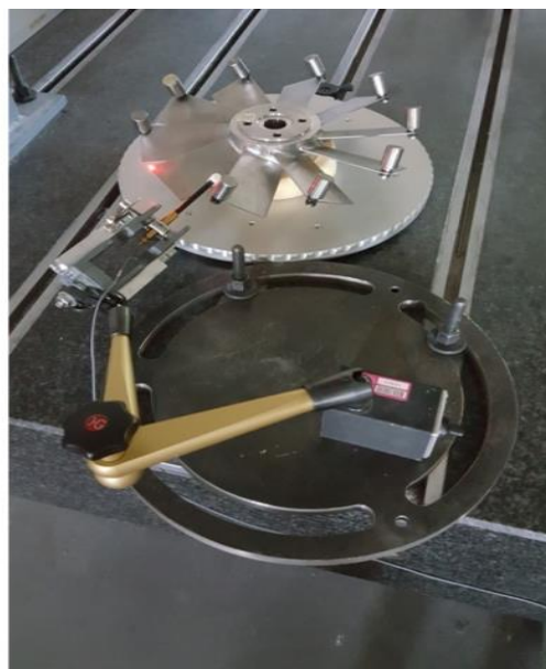
Рисунок 7 – Экспериментальное исследование расстройки параметров академического колеса
