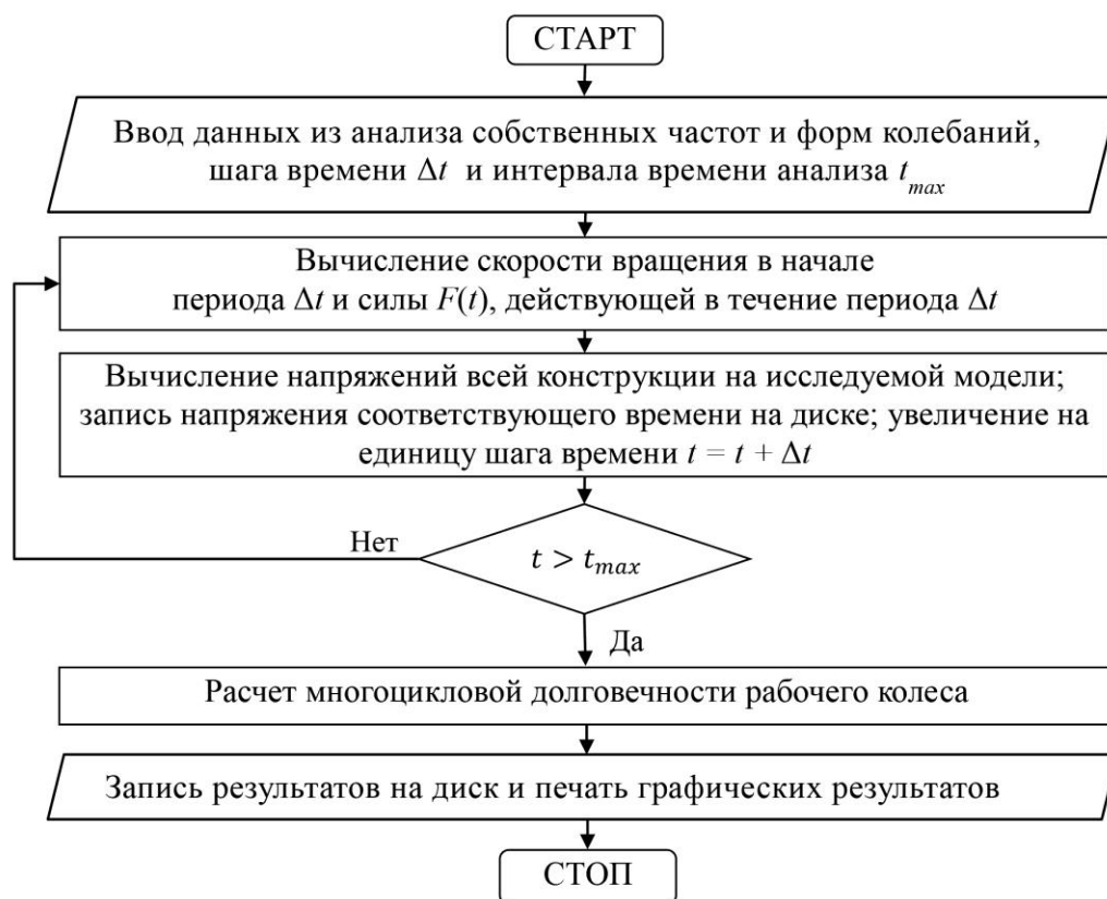
Рисунок 5 – Блок-схема алгоритма для расчета многоциклового усталостной долговечности
