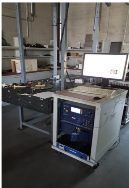
Рисунок 7 – Экспериментальное исследование расстройки параметров академического колеса
