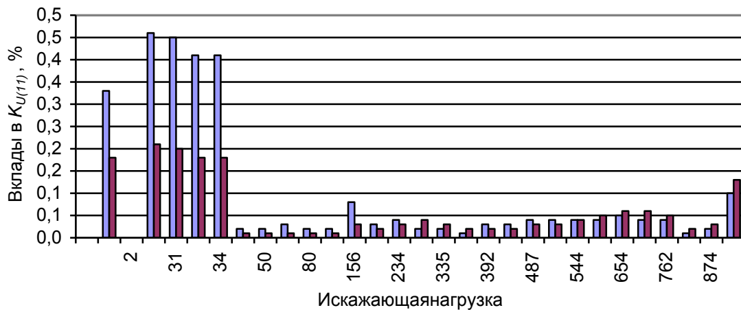
Рис. 7.52. Вклады искажающих нагрузок в K_{U(5)} (а) и K_{U(11)} (б) узла расположенного на 654 км. 1–исходная схема, 2- схема с фильтрами.
