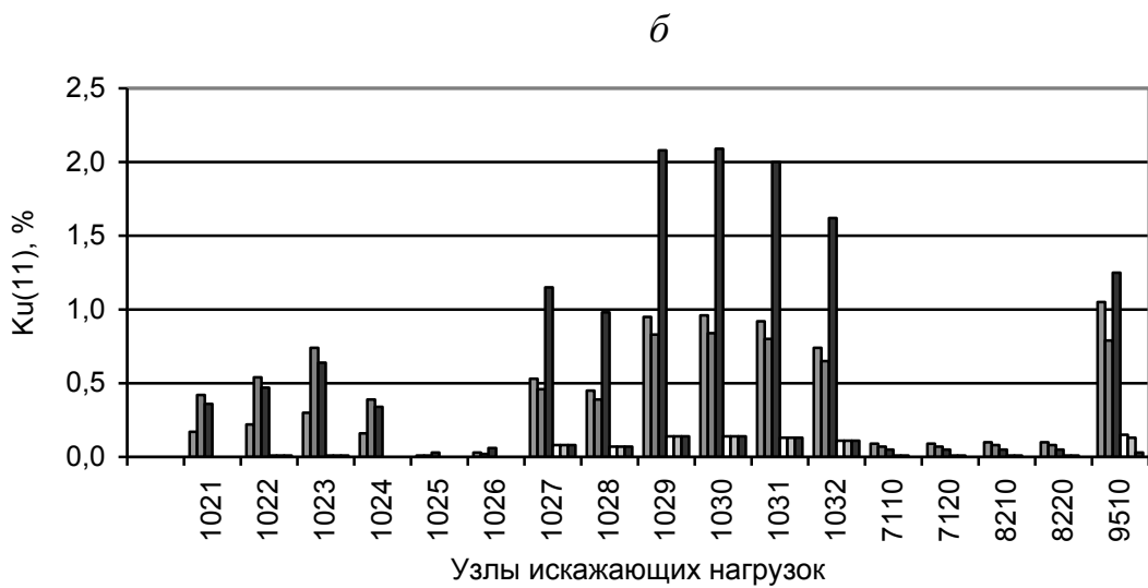
Рис. 7.57. Вклады искажающих нагрузок в K_{U(11)} для 1-й ( a ) и 2-й ( б ) системы шин 220 кВ БРГЭС в исходной схеме при установке фильтров и при коммутациях. 1– исходная схема (без фильтров); 2- отключен АТ1 в исходной схеме; 3- отключен АТ2 в исходной схема; 4 – установлены фильтры; 5– установлены фильтры, отключен АЕ1; 6-установлены фильтры, отключен АТ2.
