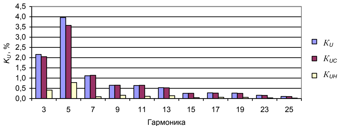
Рис. 3.40. Вклады сети и нагрузки в коэффициент искажения напряжения фазы А.
