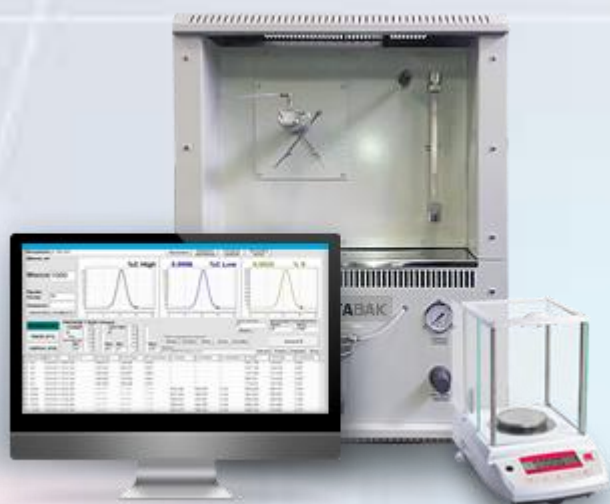
Анализатор углерода и серы Метавак CS Углерод – от 0.005 до 100 % Сера – 0.001 до 5.0%
