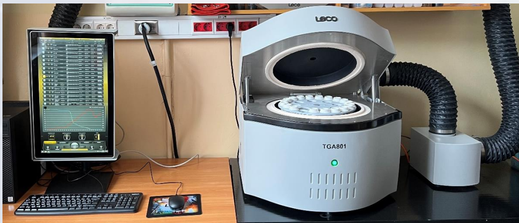
Макротермогравиметрический анализатор TGA 801 – определение влажности, выхода летучих веществ и зольности ТОПЛИВ
