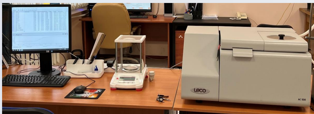
Изоперебалический калориметр AC 500 – определение теплоты сгорания топлив
