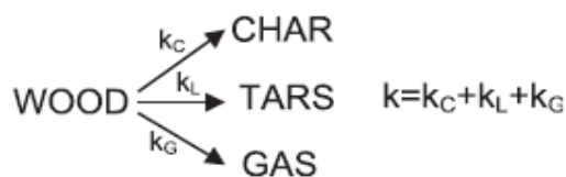
Рисунок 3.2. Механизм пиролиза древесины на первой стадии.
