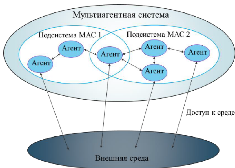
Рисунок 1.3 – Принципиальная структура мультиагентной системы
