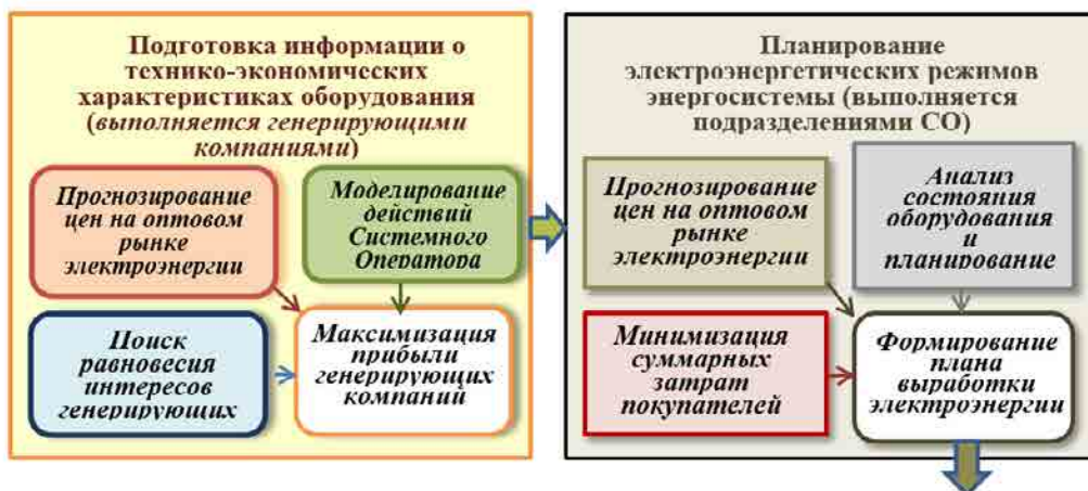
Рис. 32. Взаимодействие задач при планировании электроэнергетических режимов энергосистем.
