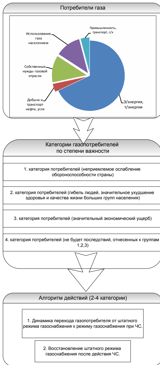
Рис. 52. Схема принятия решений по выбору режима функционирования объекта – потребителя газа при ЧС с газоснабжением.
