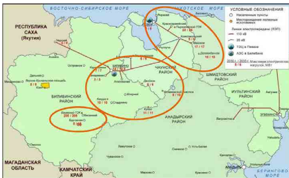
Рис 79. Центры электрических нагрузок Чаун-Билибинского энергоузла.
