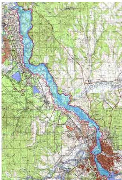
Рис. 82. Границы зон затопления нижнего бьефа Иркутской ГЭС при равномерном подъёме уровня р. Ангары на 5 и 7 м.
