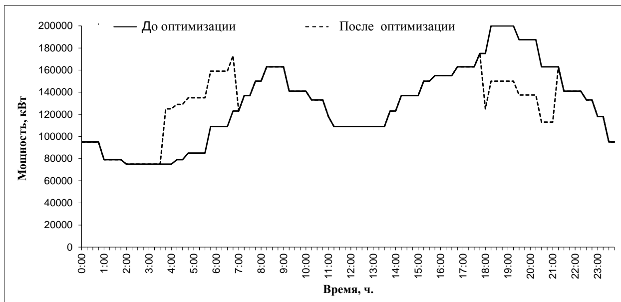
Рис. 4.6. Обобщенный график потребления активной мощности медеплавильного завода до и после оптимизации
