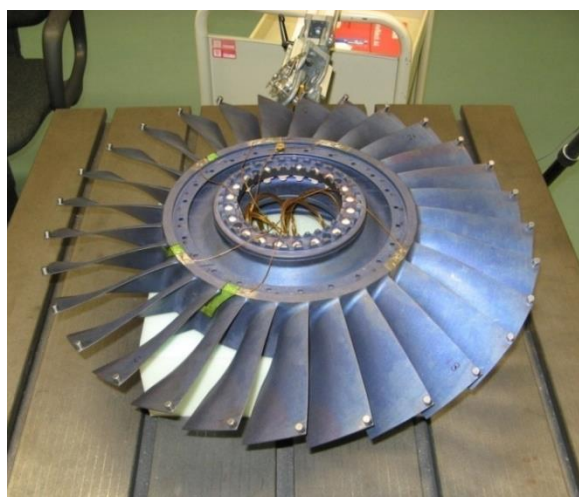
Рисунок 1.6 – Рабочее колесо фирмы Rolls-Royce с расположением дополнительных масс на лопатках
